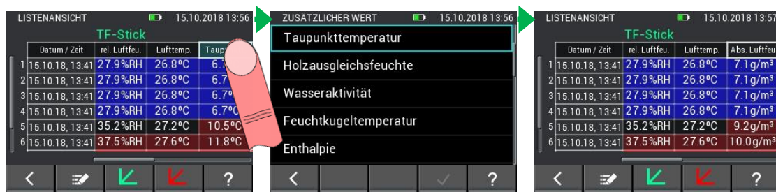
Abbildung 9-10: Anzeige des zusätzlichen Wertes in der Listenansicht wechseln
