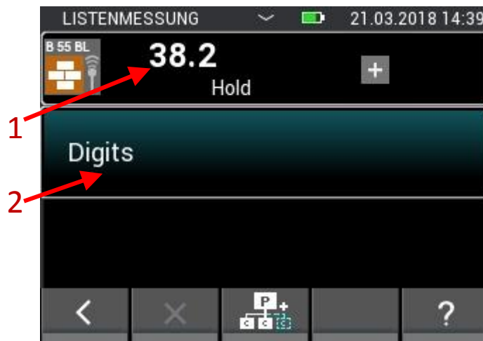
Abbildung 7-16: Messbildschirm der Listenmessung mit kapazitiver Baufeuchtemessung mit einer B55 BL
