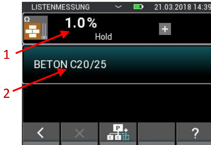
Abbildung 7-12: Messbildschirm der Listenmessung mit widerstandsbasierter Baufeuchtemessung
