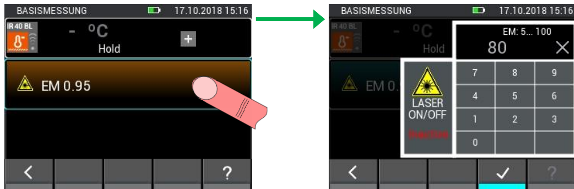
Abbildung 5-30: Menü zur Einstellung des Emissionsfaktors und zur Aktivierung des Laser bei IR 40 BL
