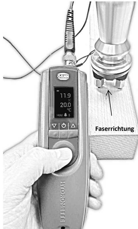
Abbildung 14-1: Holzfeuchtemessung – quer zur Faserrichtung
