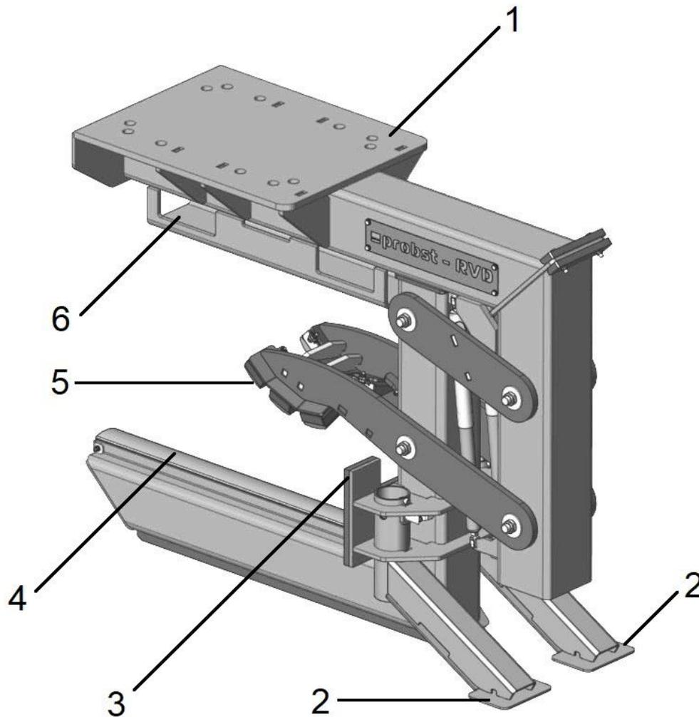
1. Flanschplatte zum Anbau von hydraulischen Drehwerken
