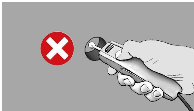
Abbildung 7-5: Falsche Anwendung - Messung im Bohrloch
