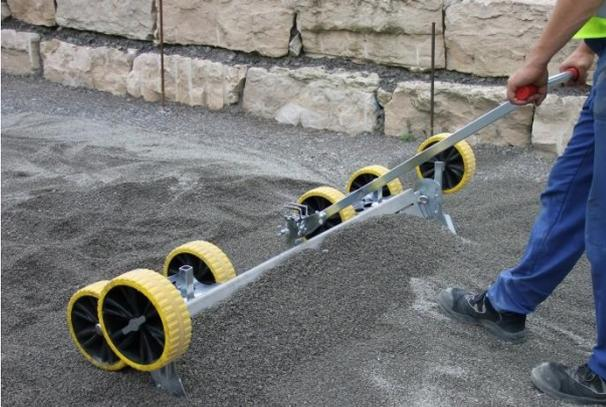
Zum Vorverteilen von Material werden die Räder auf der Schiene nach oben verschoben. Siehe Kapitel „Einstellen der Laufhöhe der Räder“.
