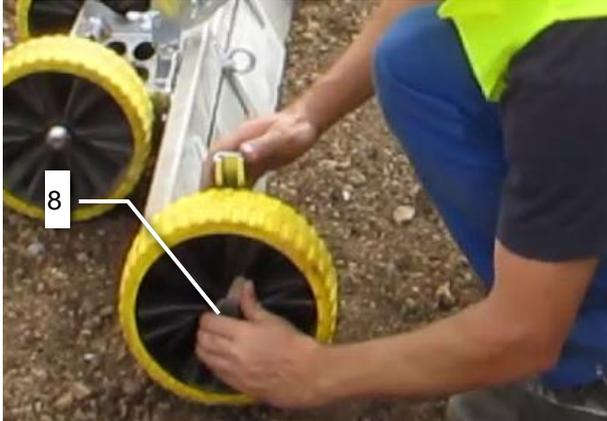
2. Laufhöhe durch Verschieben des Rades entlang der Schiene einstellen. Die Skala an der Schiene (siehe Bild) zeigt den Abstand von der Radunterkante bis zur Unterkante der Abziehschiene (5) an.
