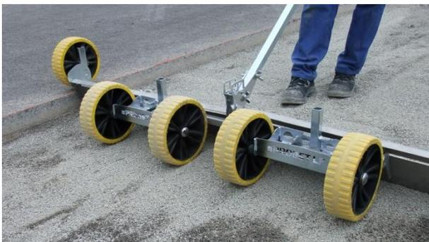
Für das Planieren entlang eines Bordsteins wird eines der Räder in der Laufhöhe auf den Bordstein eingestellt.
