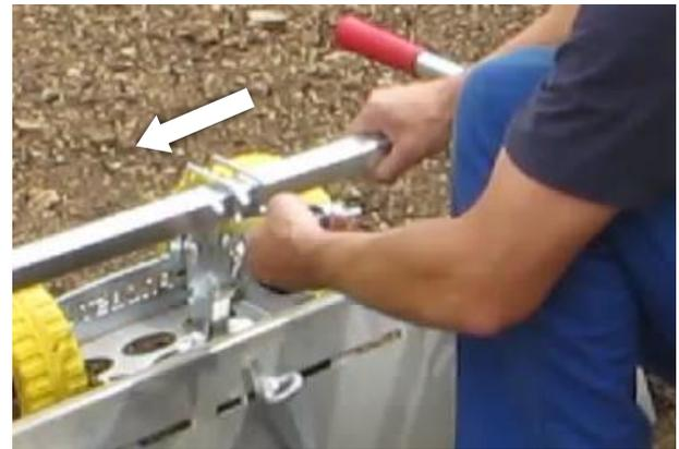
4. Flügelschrauben (2) durch die Bohrungen der Handgriffführung durchstecken und mit Flügelmutter (3) sichern.
