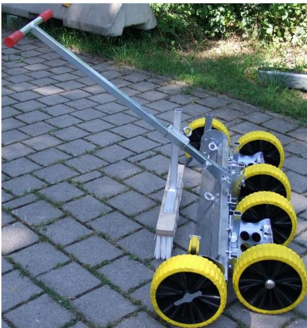
Das Kehren von Flächen funktioniert am besten, wenn die Laufhöhe der Räder etwas unterhalb der „0“-Markierung eingestellt wird.
