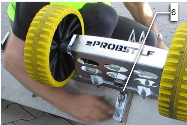
4. Abziehschienen (5) durch Ziehen an der mittleren Ringmutter (4) anheben, bis der gewünschte Winkel eingestellt ist.
